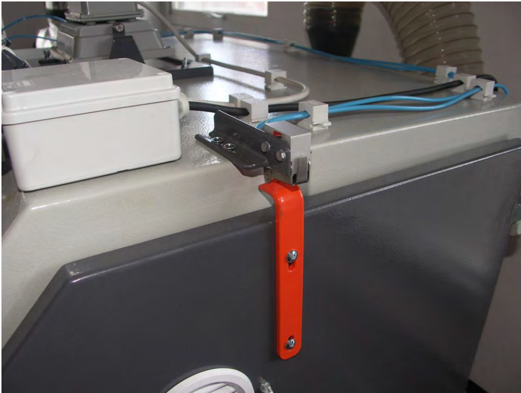
Ochrana (pneumatická okružová) procesu tryskání stop/start
